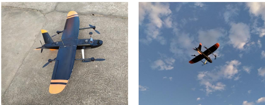
Figura 1 – VANT desenvolvido na UFOB: a) preparação para decolagem; e b) decolagem em VTOL e transição para voo com empuxo na horizontal
