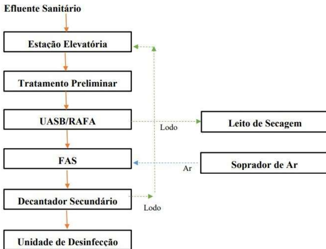
Figura 1 - Fluxograma da Estação de Tratamento de Esgoto
