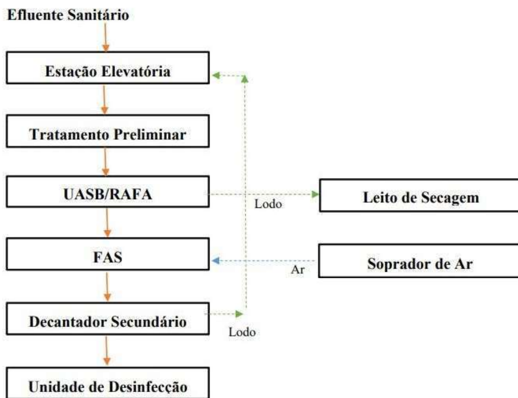
Figura 1 - Fluxograma da Estação de Tratamento de Esgoto
