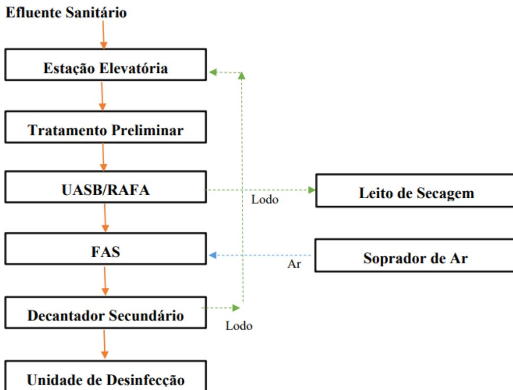
A estação elevatória possui a finalidade em realizar o recalque hidráulico das águas residuárias para que ela se eleve até a cota necessária para iniciar o tratamento. No tratamento preliminar composto pelo gradeamento e desarenador, ocorre respectivamente, a retirada dos sólidos grosseiros e a remoção de materiais sedimentáveis, especialmente areia por meio de ação física.
