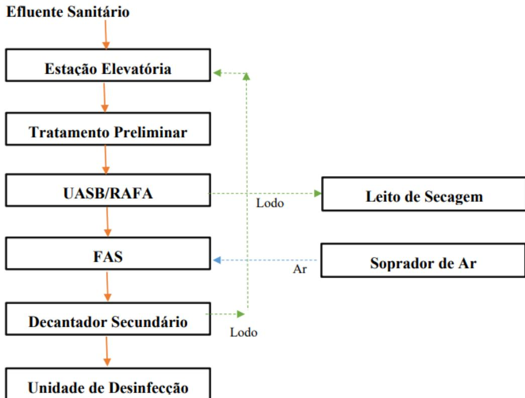
A estação elevatória possui a finalidade em realizar o recalque hidráulico das águas residuárias para que ela se eleve até a cota necessária para iniciar o tratamento. No tratamento preliminar composto pelo gradeamento e desarenador, ocorre respectivamente, a retirada dos sólidos grosseiros e a remoção de materiais sedimentáveis, especialmente areia por meio de ação física.
