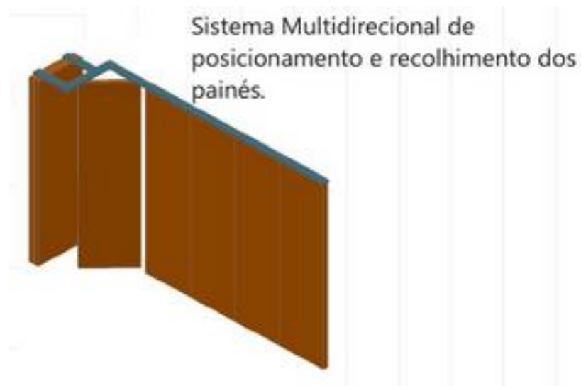
Figura 3. Sistema de posicionamento dos painéis acústicos articulados.
